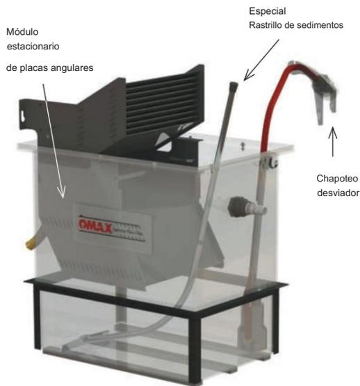
Al limpiar el tanque, el módulo de placa en ángulo extraíble se puede levantar de la unidad de accesorios. Un operador puede limpiar el sedimento debajo de las placas fijas en ángulo usando el rastrillo especial para sedimentos.
